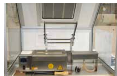
BAINS AVEC PANTO TRANSFERT : exemple d'un poste avec un pantographe qui assure le transfert entre le bain et le fluxeur
