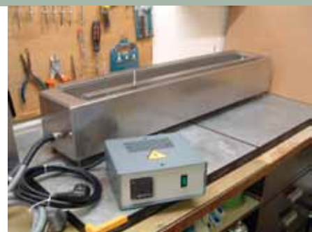
CREUSET LONG : exemple d'un bain long 1.20m
