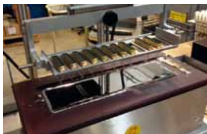
BARETTE CONNECTEUR : exemple d'outillage monté sur robot ( dans ce cas, outillage pour connecteur )
