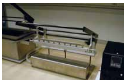
BAC A FLUX : poste de fluxage avec pantographe, accepte les mêmes outils porte composant que le robot
