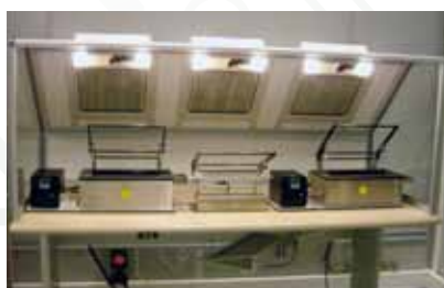
Exemple d'un poste complet dédorage/fluxage/etamage avec pantographe
