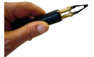
CCT : Couteau Thermique (découpe tresse, frets..)
