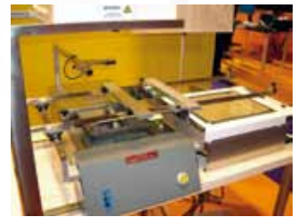
MV500 mini vague avec système montée/baisse et table de translation x,y
