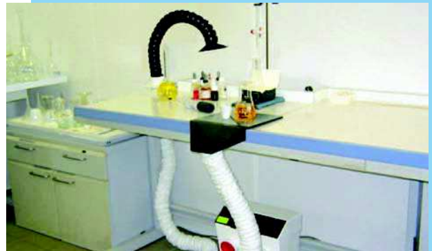
Hotte multipostes HI4P4S en situation de travail dans un laboratoire.
