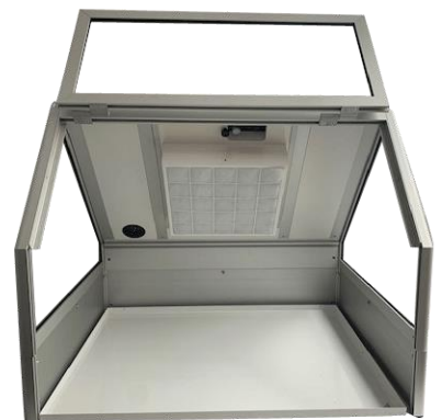
Cabine d'aspiration pour filtration HEPA Filtre HEPA H14 laissant passer au maximum 0.005% des particules de 0.1 micron Débit nominal : 150 m 3 /h Dimensions : 420 x 341 x 146 mm
